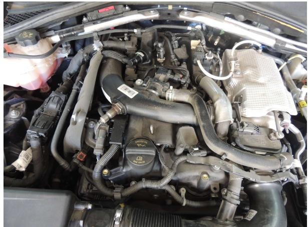
Desserrez le collier et débranchez le tuyau d'air du débitmètre (1).
