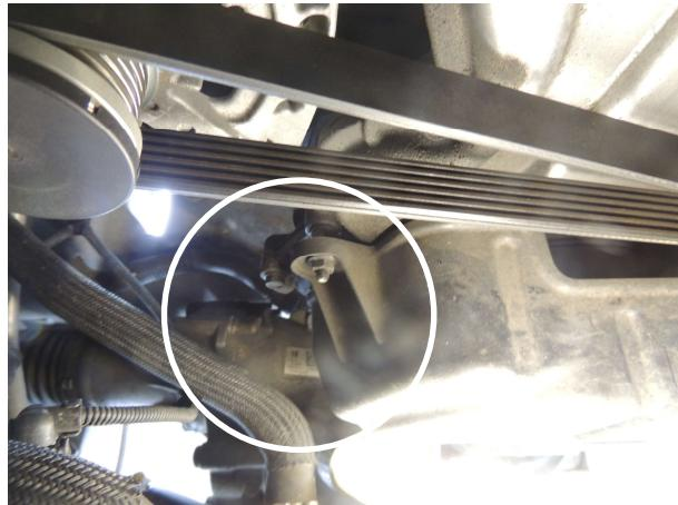
Détendre la courroie et la retirez (empreinte carré de 10mm dans le tendeur)
