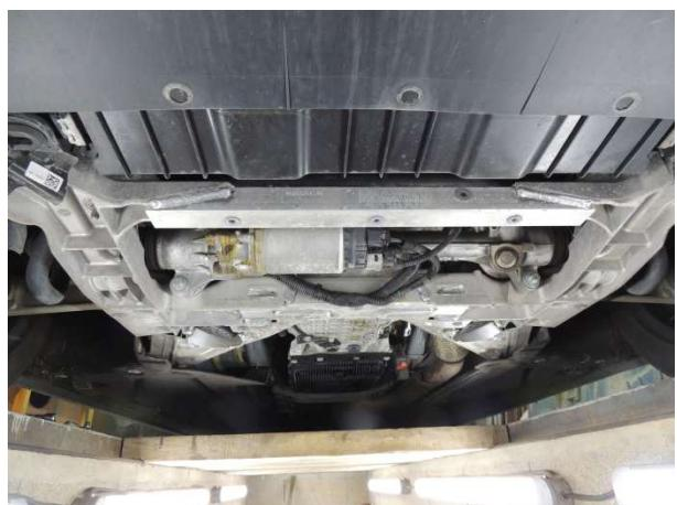
Démontez le carter de protection inférieure de la courroie d'accessoires
